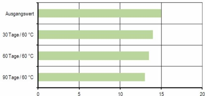
Die Tests wurden bei einer Temperatur von 20°C an typischen Stahl-Stahl Verbindungen nach einer Alterung bei 60°C durchgeführt. Am Ende von 3 Wärmezyklen mit einer Dauer von jeweils 24 Stunden von -40°C bis +100°C konnten keine Änderungen der durchschnittlichen Scherfestigkeit festgestellt werden.
