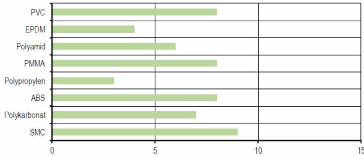
Die Tests wurden bei einer Temperatur von 20°C an typischen Kunststoff-Kunststoff-Verbindungen nach 48 Stunden Aushärtung bei 20°C durchgeführt.
