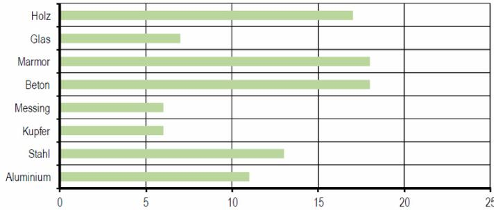
Die Tests wurden bei einer Temperatur von 20°C an typischen Metall-Metall-Verbindungen nach 48 Stunden Aushärtung bei 20°C durchgeführt.
