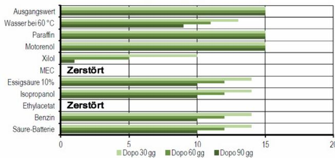
Falls nicht anders angegeben, wurden die Tests bei 20°C durchgeführt nach Eintauchen für 30, 60 und 90 Tage bei 20°C an typischen Stahl-Stahl Verbindungen nach 48 Stunden Aushärten bei 20°C.
